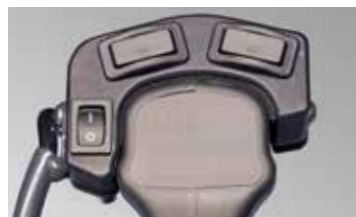
Elektrische sturing van toebehoren via joystick
